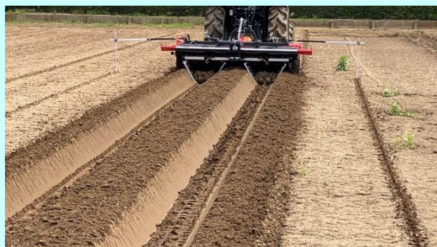
TASW-203による【谷あげ成形】作業 ※オプション品のラインマーカー(OLM-01)を装着
