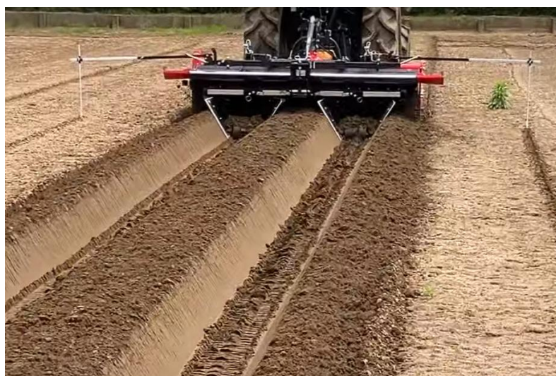
谷上げ成形機(TASW-203)との同時作業
