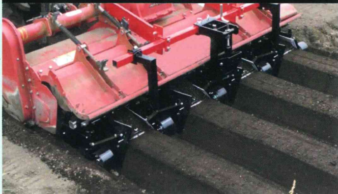
KSDE401でのうねたて作業 ※補強金具はKSDE401のみ標準装備
