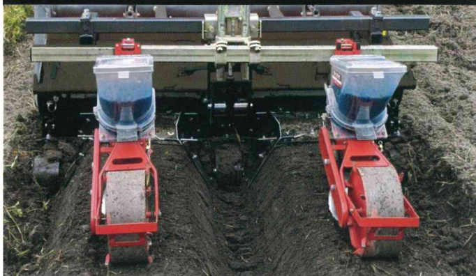
KSH201に播種機を装着し 【2畦うねたて同時接種】作業の様子
