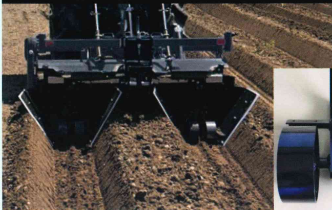
TAS-203による【谷あげ成形】作業
